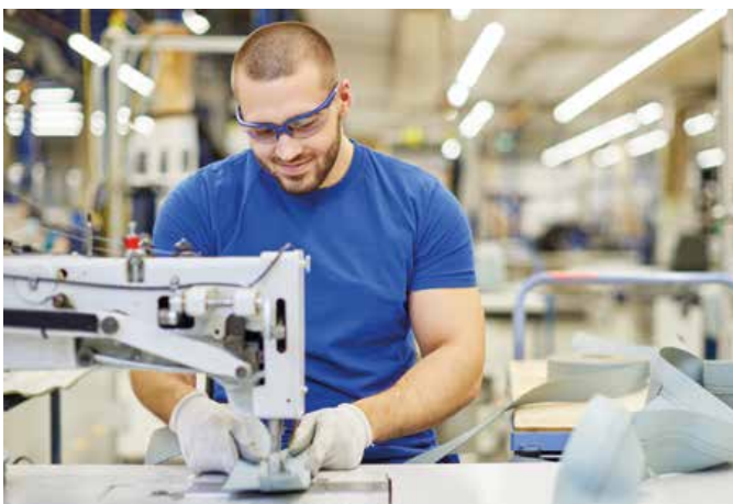
Seite 36 Die Anfertigung von Faltenbälgen ist nach wie vor mit viel Handarbeit verbunden ...
