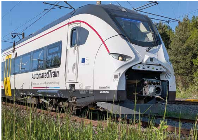
Der AutomatedTrain auf Basis eines Siemens Mireo Plus H zeigt die Möglichkeiten des fahrerlosen Bahnverkehrs auf.
